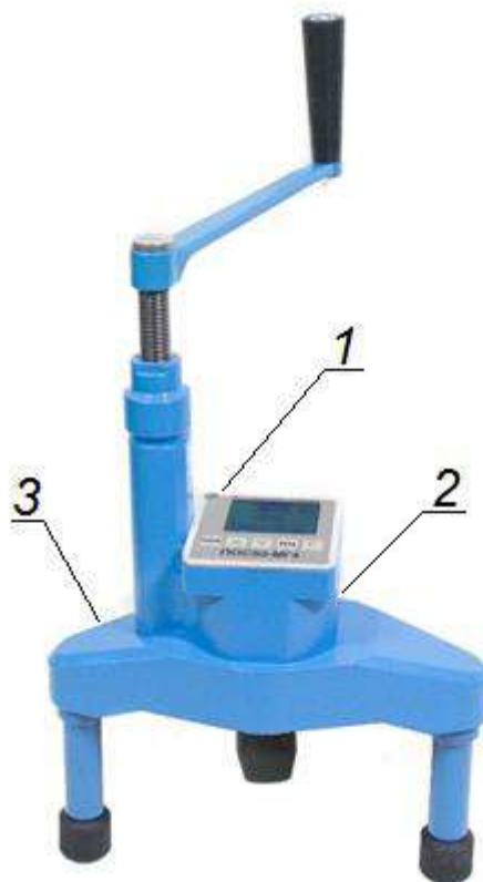
1 – электронный блок 2 – силовозбудитель 3 – опорная плита Рисунок 1 – Общий вид измерителей прочности бетона ПОС- 60МГ4.П.1
